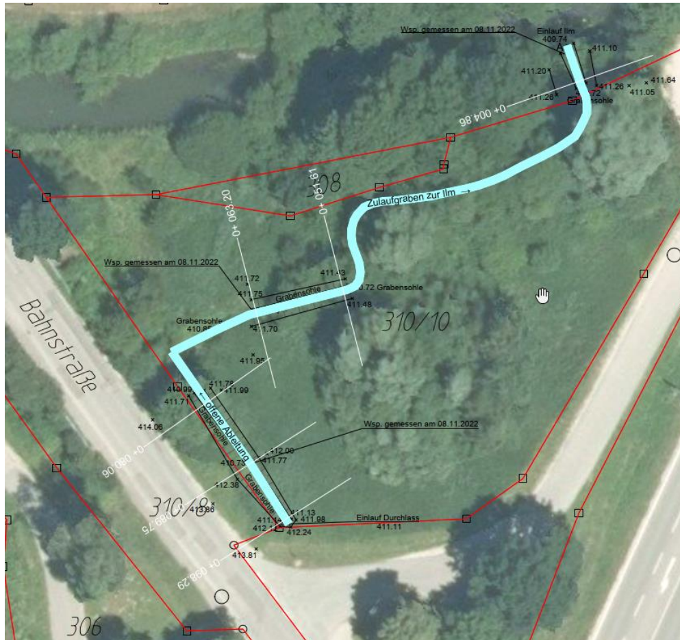
Abbildung 2-1: Verlauf offene Ableitung und Zulaufgraben zur Ilm
